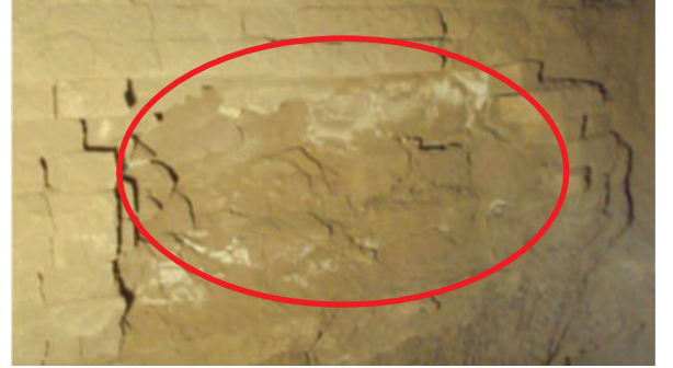
Şekil 3 . Standart yüksek alümina tuğlaların 16 aylık kullanım sonucu görünümü Figure 3. Standard high alumina bricks after 16 months of usage
